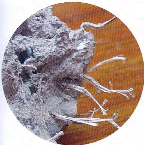
Fibras sintéticas para el refuerzo de concreto. ARCHIVO ASOCRETO
